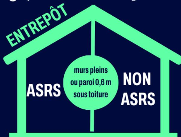
\*Cette séparation n'est pas nécessaire en cas de niveaux de sprinklage alignés entre l'ASRS et le non ASRS.
